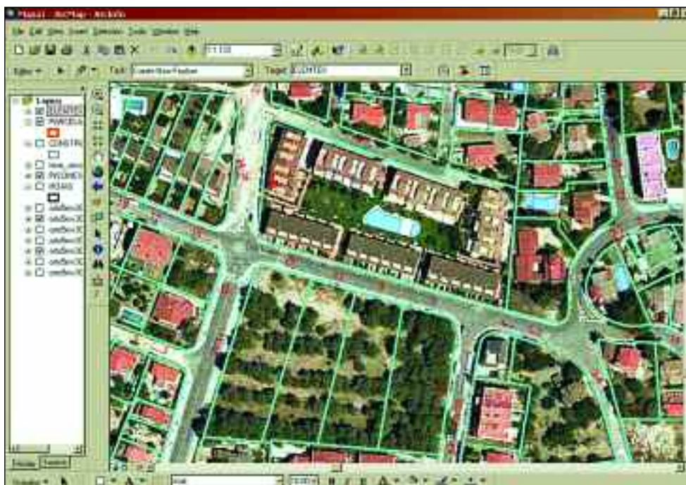
Figura 14: Superposición del ortofotomapa y la cartografía digital urbana utilizando el módulo ArcMap: Barrio de Sant Jordi (Torredembarra).
